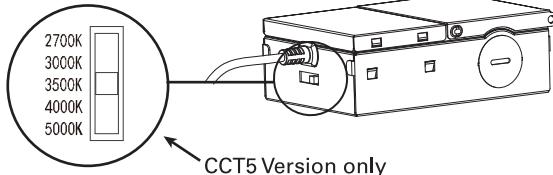
1. TURN OFF THE POWER AT THE ELECTRICAL PANEL BEFORE STARTING INSTALLATION. MAKE CUTOUT FOLLOWING THE CUTOUT DIMENSIONS AND SELECT DESIRED COLOR TEMPERATURE BY SLIDING THE SWITCH ON THE J-BOX.
